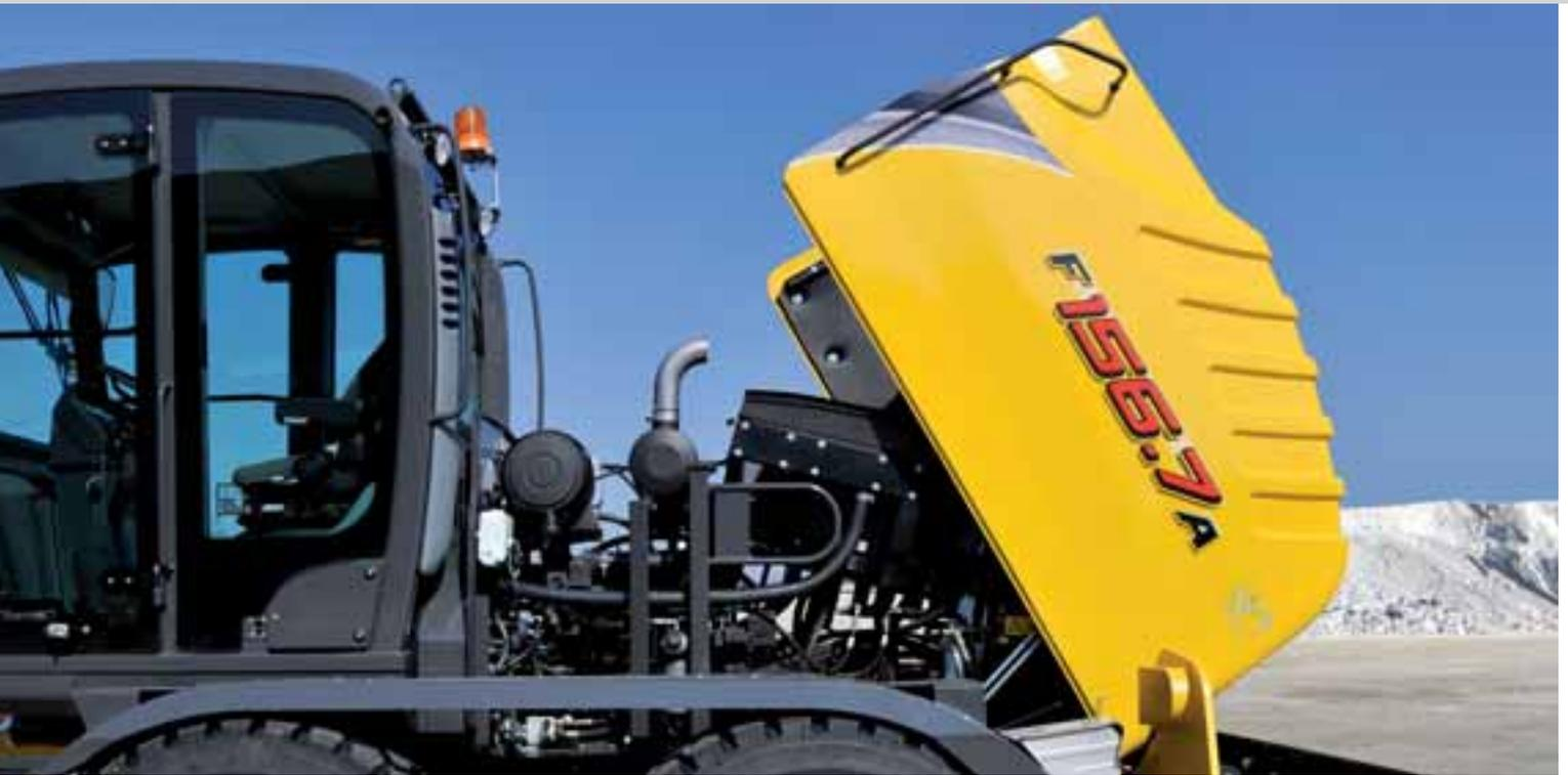
Der FPT Common Rail-Motor wurde für mehr Leistung und Produktivität bei gleichzeitiger Senkung von Kraftstoffverbrauch und Schadstoffemissionen entwickelt.
