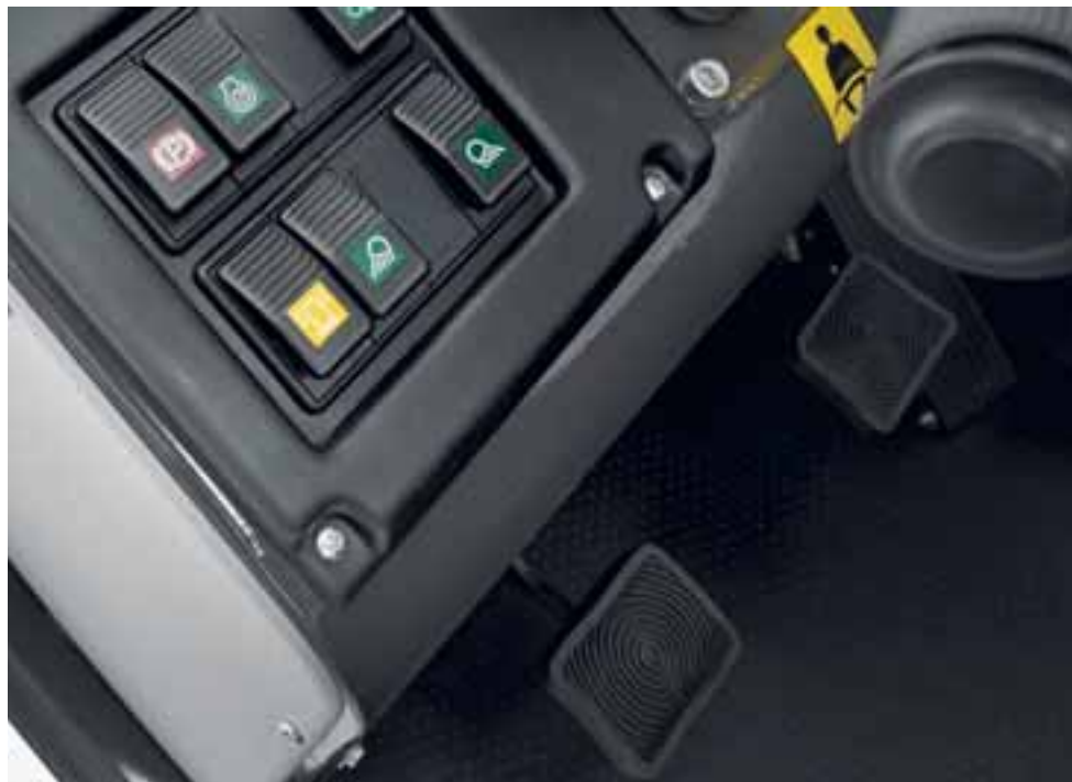
Mit dem Inchpedal kann der leistungsfähige hydrostatische Fahrtrieb moduliert werden
