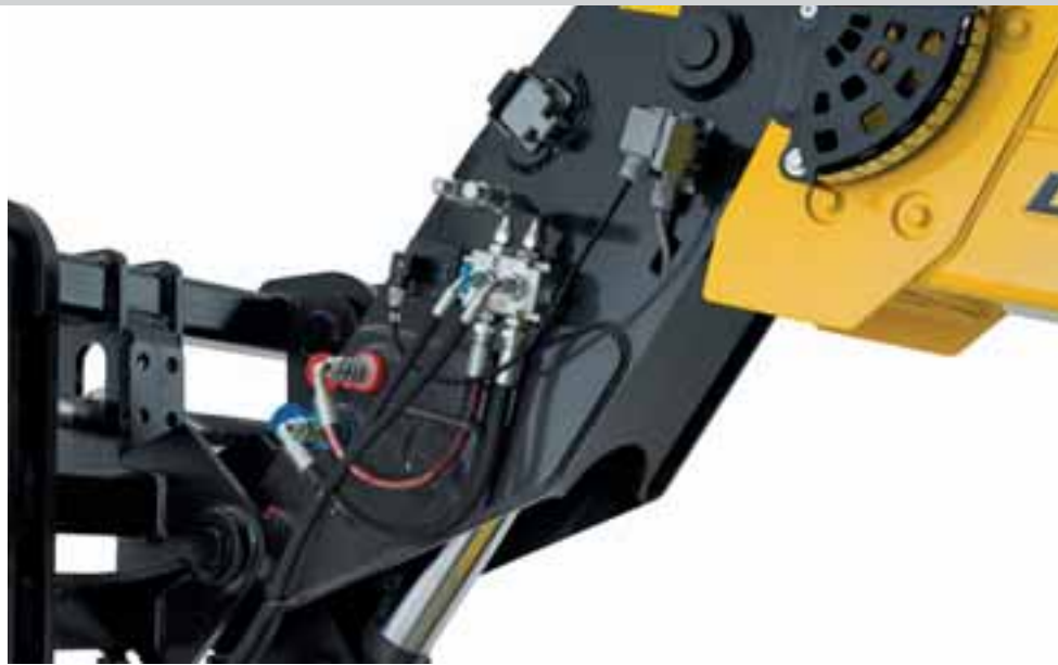
Der Zusatzkreislauf am Ende des Teleskoparms versorgt jedes Gerät mit der nötigen Ölmenge
